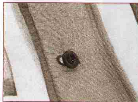
ORICALCO, A MEMORY SHAPE FABRIC WITH NITINOL, BY GRADO ZERO ESPACE. | ORICALCO, UN MATÉRIEL À MÉMOIRE DE FORME FABRIQUÉ À PARTIR DE NITINOL, PAR GRADO ZERO ESPACE.
